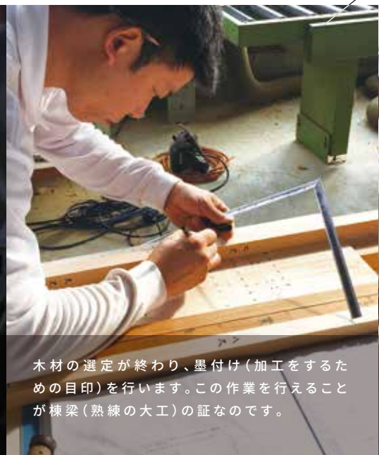
木組みは木の癖組なり。一本一本、木の癖を見極めていきます。何年たてばどれだけ、どう反ってくるか、大工の目にかかれば一目瞭。これは機械では決して真似をすることができません。
